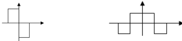
شکل ۳۳-۶ دو سیگنال زوج و فرد که هر دو دارای یک صفر در مبدا (صفحه ۵) هستند.
